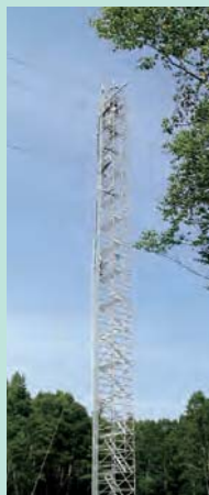
二酸化炭素吸収量観測機器
