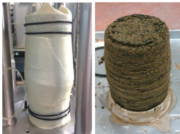
■CD試験後の供試体の状況(有効拘束圧 $\sigma'_c=150\text{kPa}$ )
