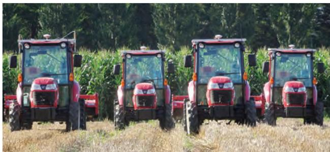
ロボットトラクタ4台の協調耕うん作業。複数ロボットによる協調作業は、農家の方のアイデアがヒントとなって実現したシステム（左）
