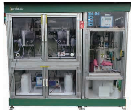
CO 2 分離回収システムの小型実証機
